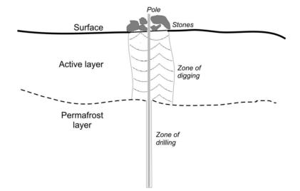
Fig. 6. Schema of point Nr. 4002 stabilisation.
