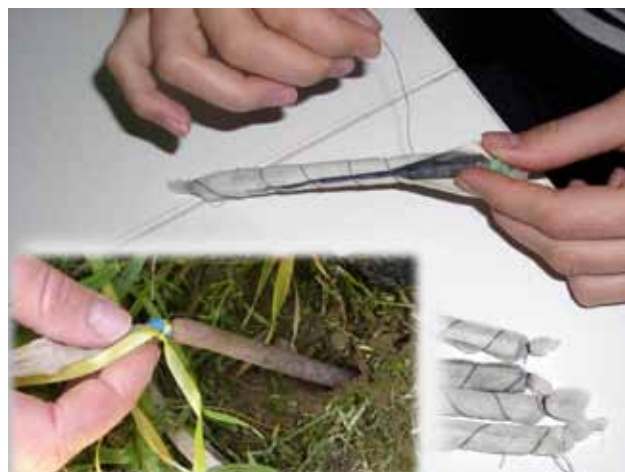
Obr. 5. Znárodnění přípravy iontoměničových sond, jejich obalování surovým hedvábím a zapravování do půdy, do otvoru vytvořeného po vpichu kovovým bodcem. Foto: Jaroslav Záhora
