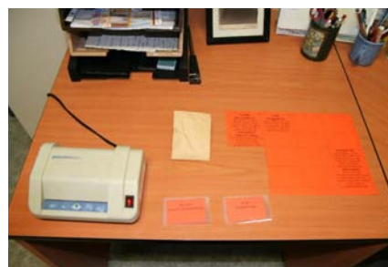
Náš nejmenší laminovací stroj a jmenovky vystřihané z papíru vložené do fólie. Po vložení do papírové kapsy projedou laminovačkou.
