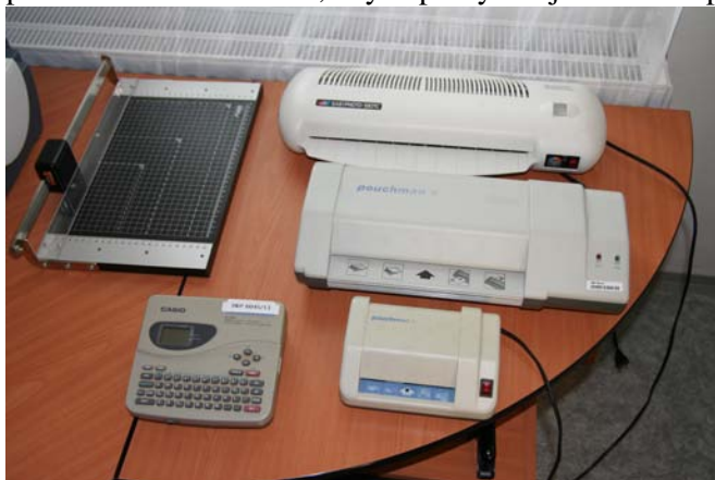
K výrobě jmenovek používáme řezačku na papír (vlevo nahoře), tři typy laminovacích strojů (vpravo pod sebou) a ruční elektronickou tiskárnu (vlevo dole).
