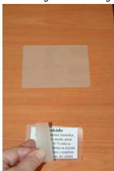
Dvě velikosti fólií k zatavování jmenovek a vkládání papírové jmenovky před laminováním.
